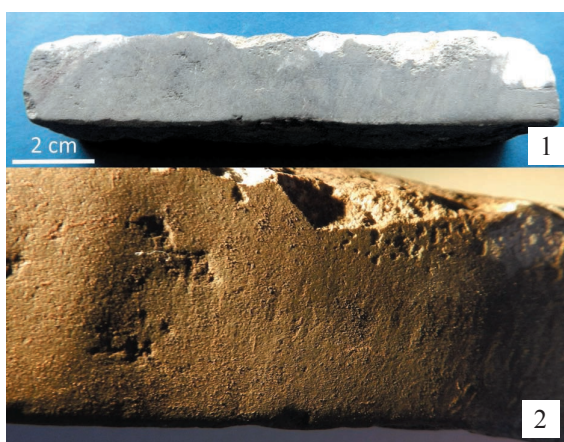
Рис. 4. Оселок (1) и участок его изношенной поверхности с характерной волнистостью (2)
