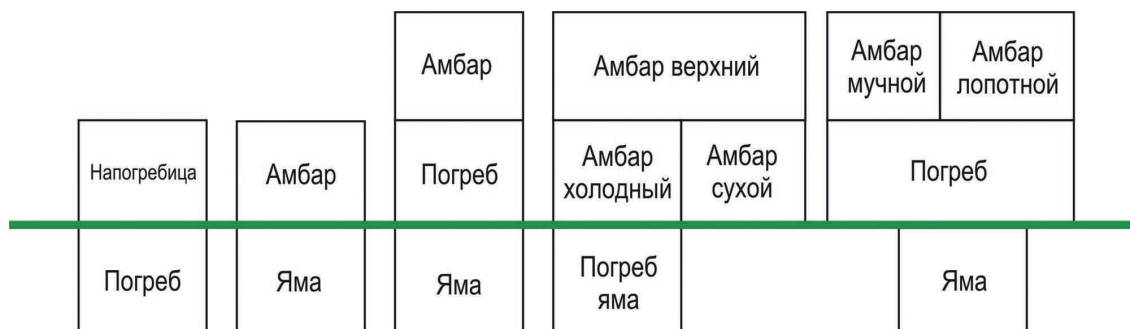
Рис. Типы вертикальной и горизонтальной планировки построек для хранения продуктов в старожильческих населенных пунктах Енисейского и Богучанского районов Красноярского края. Схема
