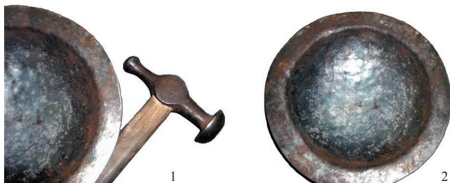
Рис. 2. Вытяжка «череп» мисюрки с помощью молотка: 1 – модифицированный молоток; 2 – заготовка «череп» после вытяжки углубления
